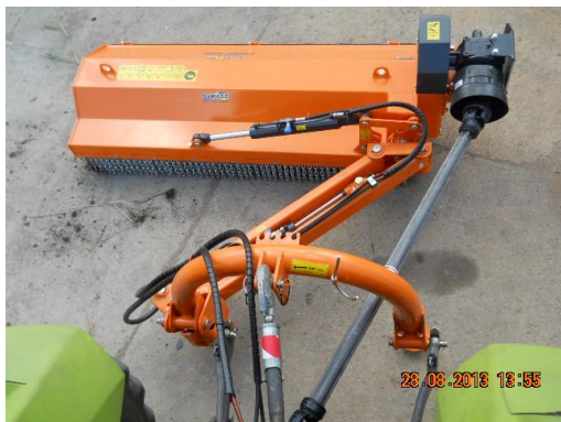
Bild 17. Gräsklipparens läge vid mätning av det fria utrymmet (cylindern är i sitt yttersta läge)
